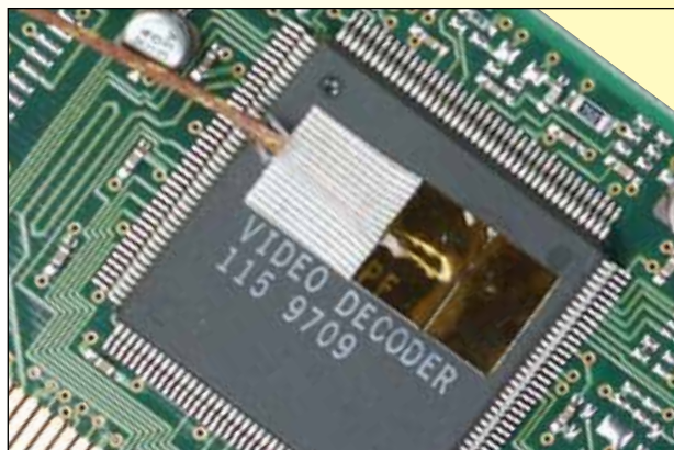
这种自粘式贴条是将传感器元件“定位”安装的理想选择。元件一旦固定好,便可“按原状”应用于电路板制造过程中电子元件的温度监测等用途。在更高的温度下,还可使用OMEGABOND®粘合至适当位置。
