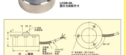
"F" 直径通孔(带 C'钻孔)
