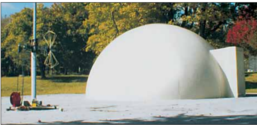
上图为analab的3米和10米(9和30英尺)露天测试场所(OATS), 用于进行排放测试。
