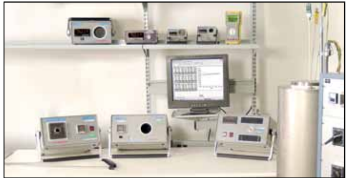
在OMEGA的校准实验室内, NIST可溯源的精密仪器用来执行精确的温度校准。
