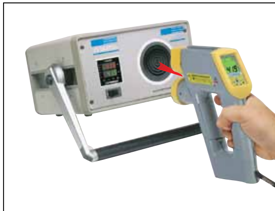
正在用来校准OS533E-DM红外线温度计的 OMEGA BB702高性能黑体校准源。
