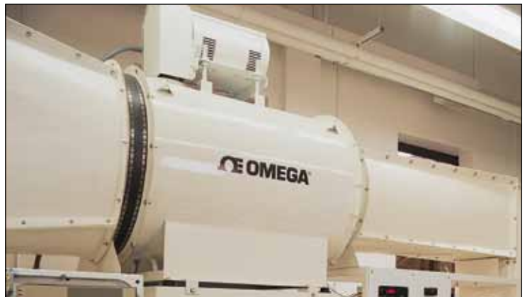
OMEGA的5米（高）x 8米（长）（15 x 25'）再循环温控风洞与 NIST可溯源空气速度标准配合使用，提供精确的流量校准。
