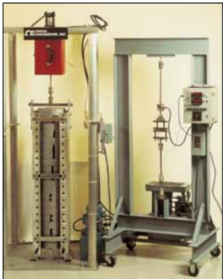
用于校准称重传感器和应变规的大容量静负载测试仪(左)和液压测试仪(右)。
