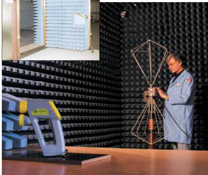
Analab保有最新、最先进的EMI/EMC测试设备，例如图中所示的双锥天线和全电波暗室。
