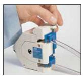
第4步:上紧螺钉将泵管固定住
