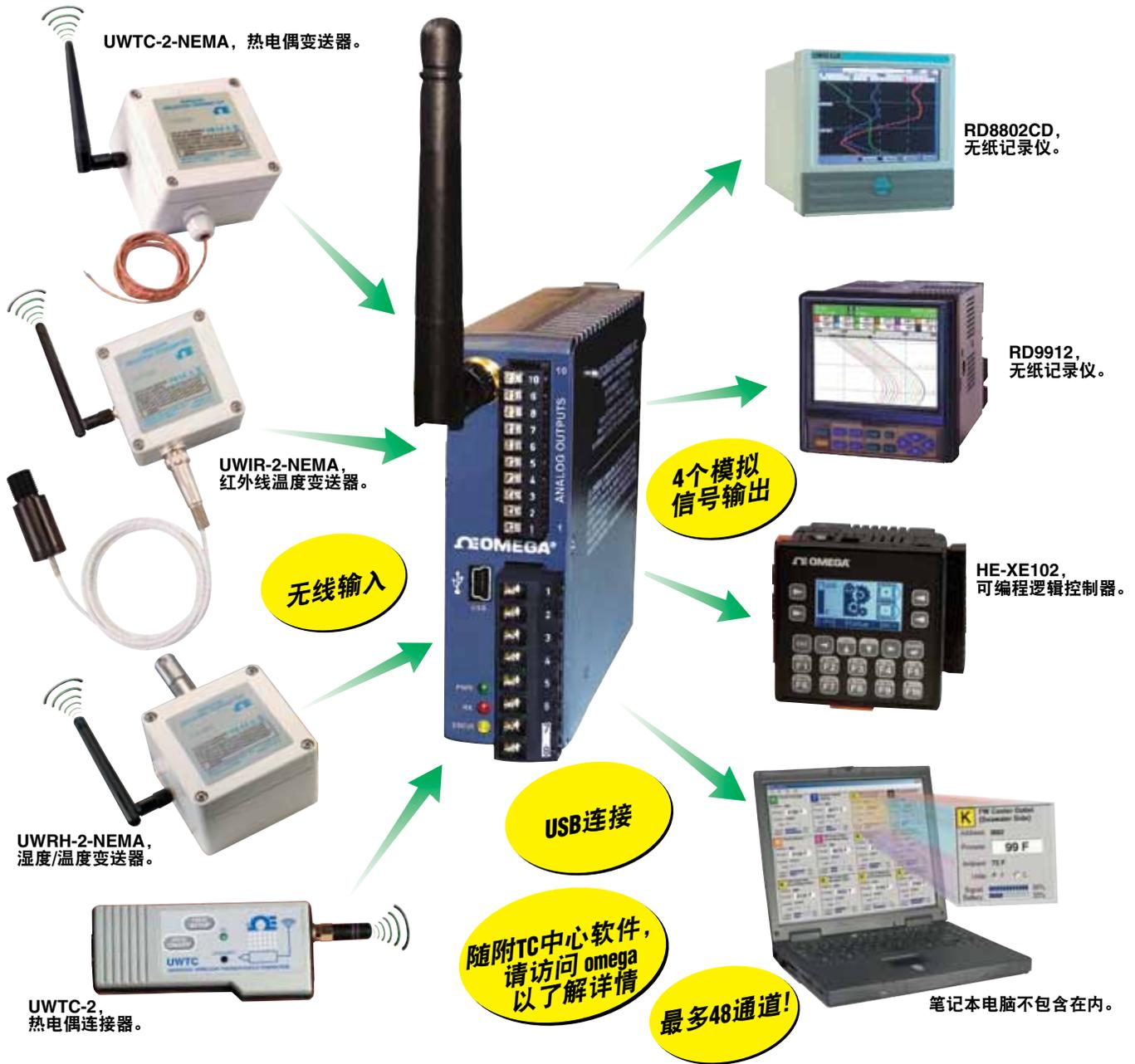
上图所示的典型系统包括任何4个无线变送器，以及一个UWTC-REC4-MA无线接收器（带模拟信号输出）和HE-XE102 PLC。（仅限接收器和PC）。
