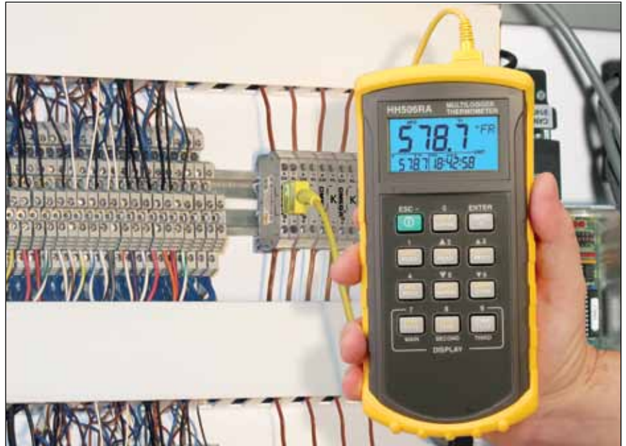
图示接线盒连接了RECK1-10电缆和HH506RA数据记录器 / 温度计（配备RS232C接口）。
